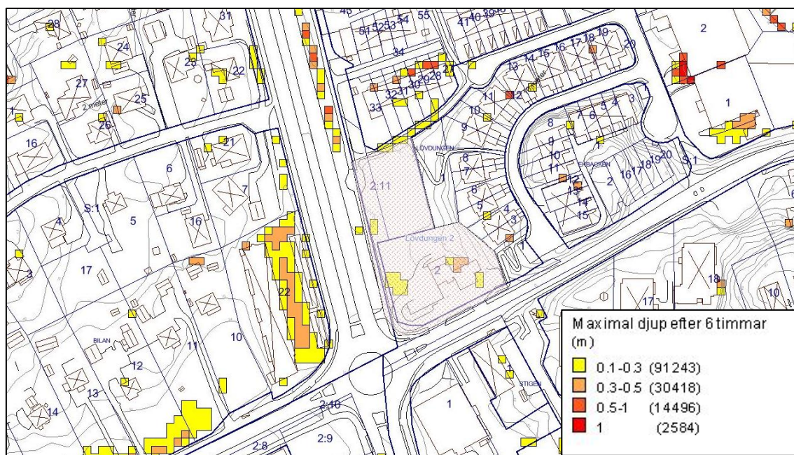
Figur 6. Simulerade vattendjup vid skyfall. De olika färgerna visar olika djup som beräknats uppstå efter 6 timmar, se teckenförklaringen. © WSP (2018)
