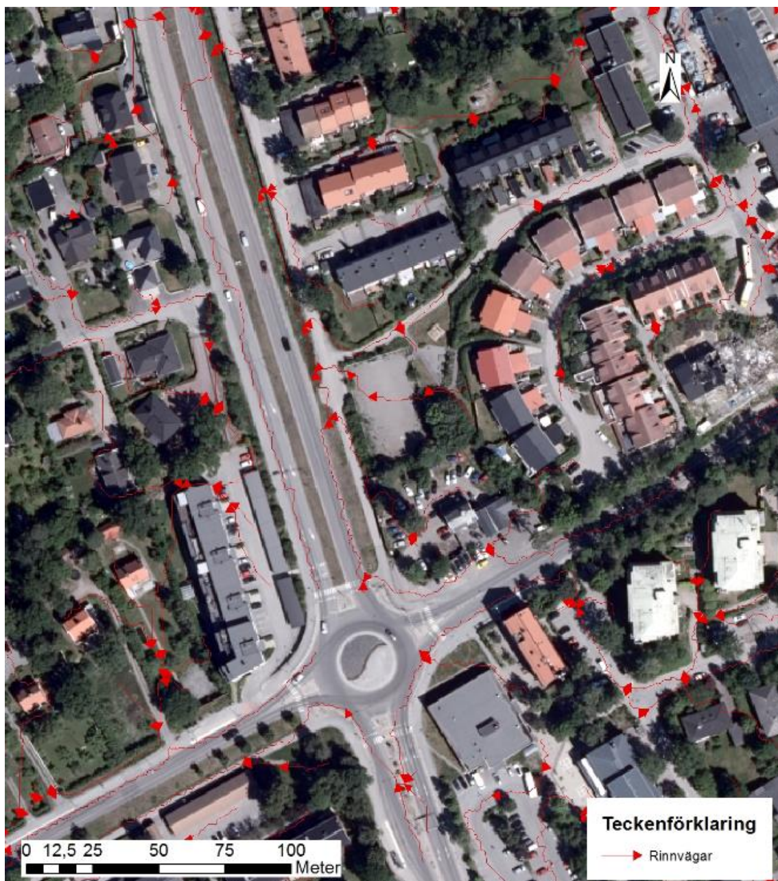
Figur 8. Rinnvägsanalys utförd i ArcGIS med tilläggswerktyget ArcHydro Tools. Ortofoto © Lantmäteriet.
