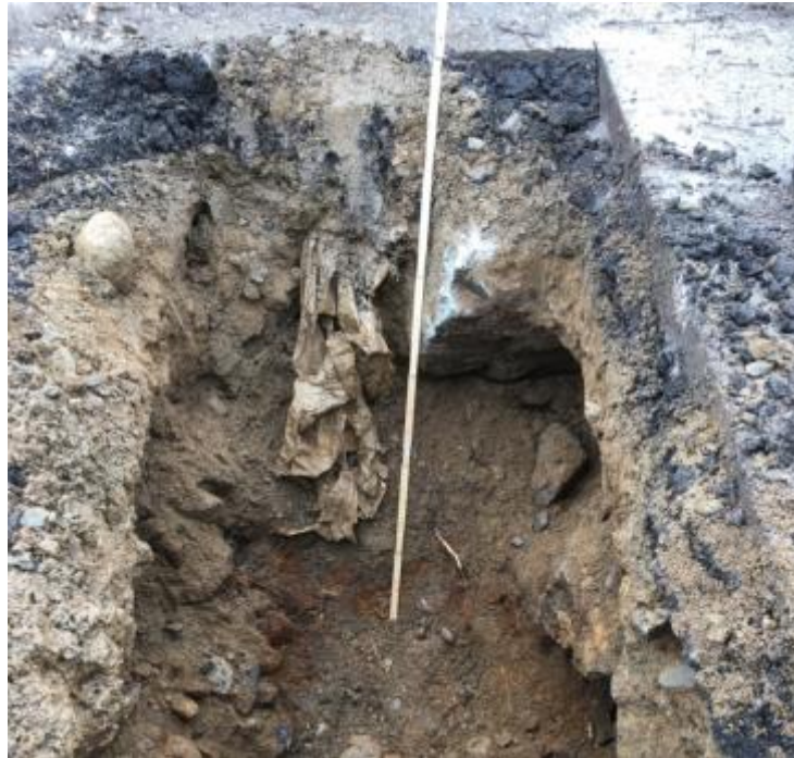
Figur 4. Visar provgropen BP10 där det provtagna materialet bestod av fyllnadsmassor och i det djupaste provet ett tunt lerlager. Schaktväggen innehöll även plastrester.
