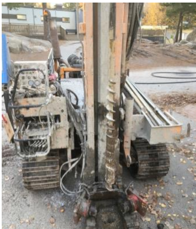
Bilden visar provtagning med borrhög och skruv.
