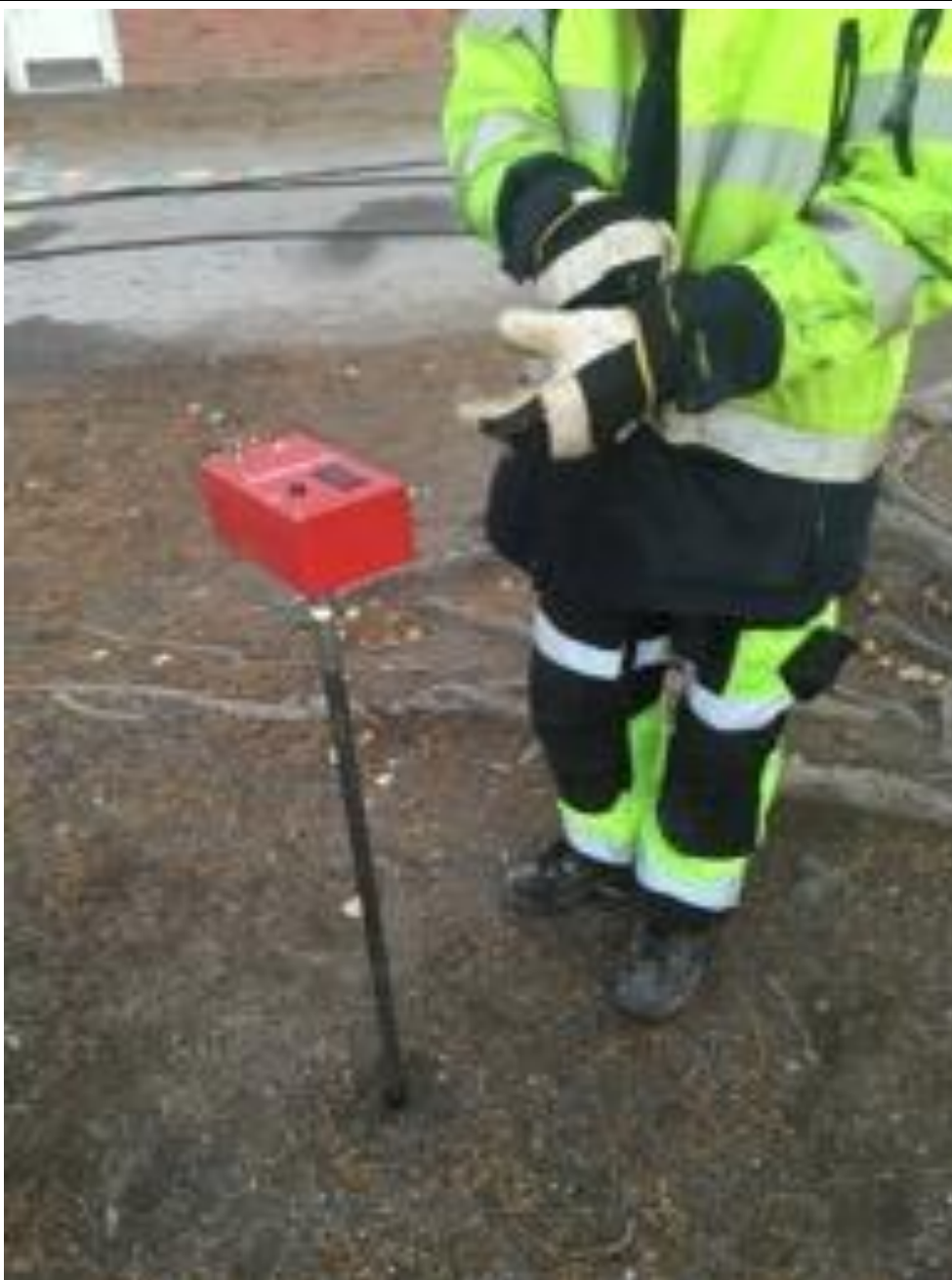
Figur 7. Figuren visar radoninstrumentet Markus10 vid användning för att mäta markradon vid Utsäljeskolan.
