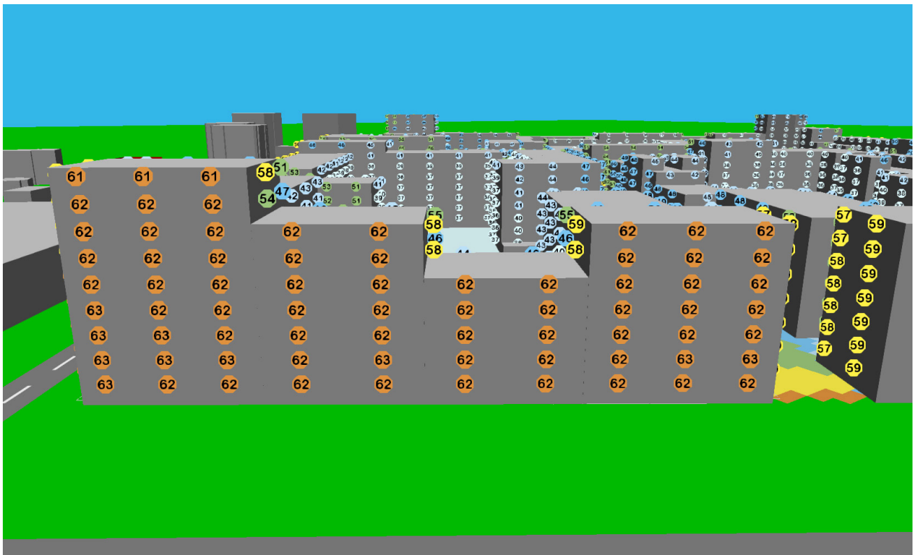
Figur 19 Kv 10 Ekvivalent ljudnivå mot Storängsleden 2017
