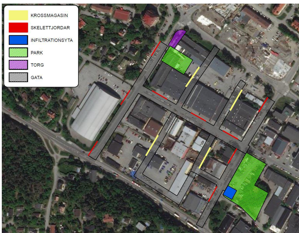
Principskiss för dagvattenhantering på torg samt park- och gatumark
