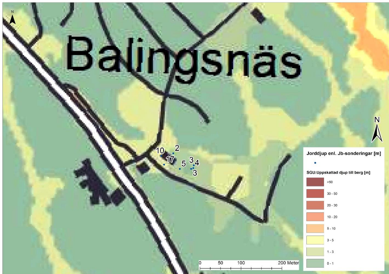
Figur 5 Jorddjupskarta från SGU, samt uppmätta jorddjup i höjdsystem RH2000 (baserat på resultaten från Jb-sonderingar).
