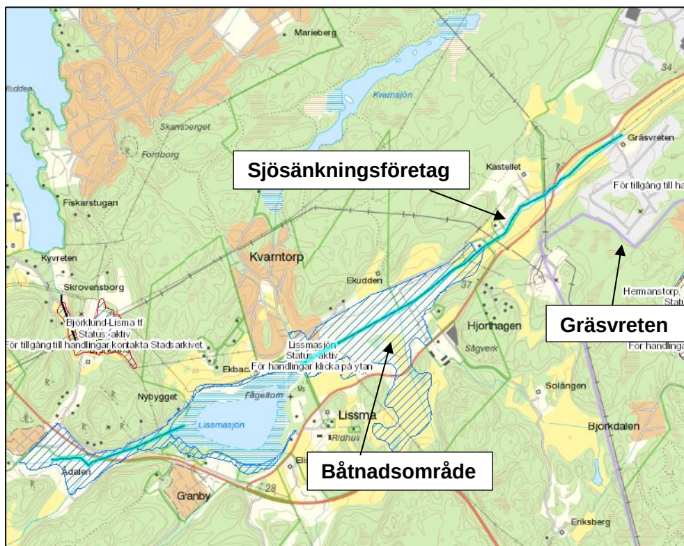
Figur 5. Lissmasjöns sjösenkningsföretag. Sträckan som sjösenkningsföretaget omfattar är markerat med en blå linje i figuren. Den streckade markeringen visar företagets båtnadsområde (Länsstyrelsen i Stockholm, 2017).
