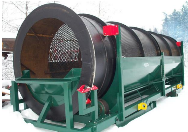
Trumsikt används som sista mekaniska steget för att utskilja den förorenade finfraktionen.
