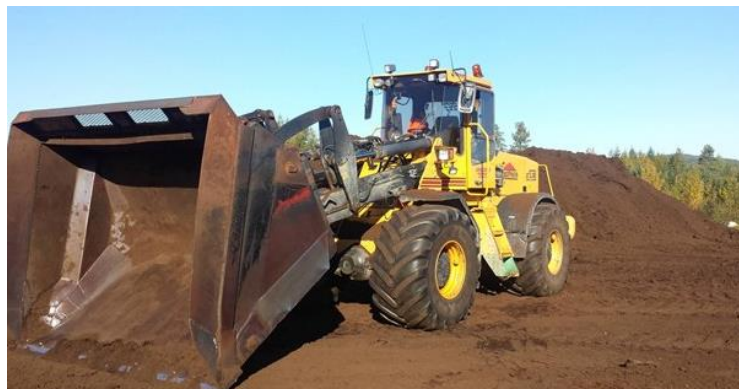
Hjullastare lastar sikten med osorterade massor och tar bort sorterade massor, fraktionssorterat
