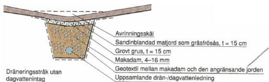
Bild 3. Ett dräneringsstråk i genomskärning (Figur 9.28 i P105).
