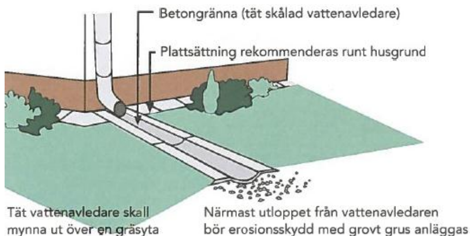
Bild 4. Utförande av stuprörsutkastare med tät vattenavledare i form av betongränna (Figur 9.5 i P105).
