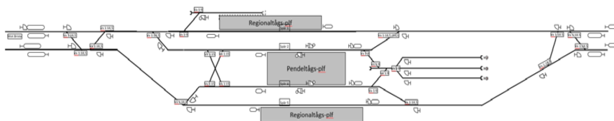
Figur 31 Ett förslag till ny utformning av Märsta station (schematisk spårskiss).
