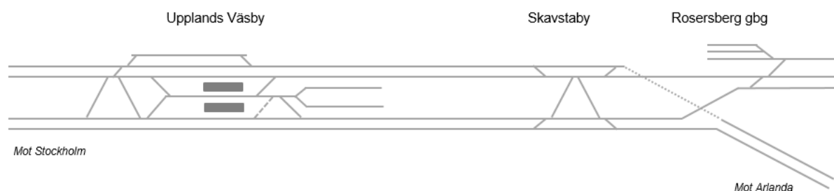
Figur 32 Anpassning av Upplands Väsby genom ny växelförbindelse mellan uppställningsspår och spår, markerad med streckad linje (alternativ A).
