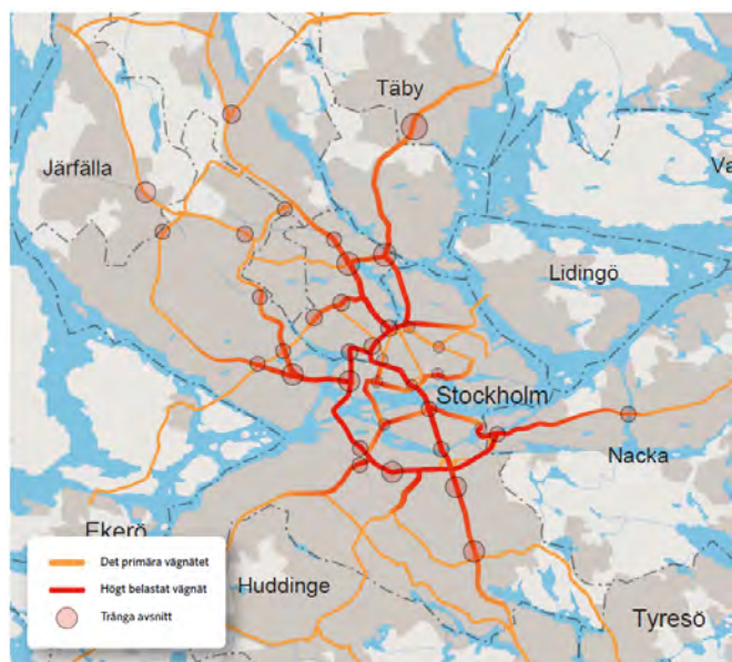
Figur 2. Karta över flaskhalsar och belastade sträckor i högtrafik ca 2015-2020. Vägnett som inte kan belastas ytterligare utan effekt för framkomligheten. Den svarta ovalen markerar väg 73 i kartan. (Källa: Trafikverket, 2014.)
