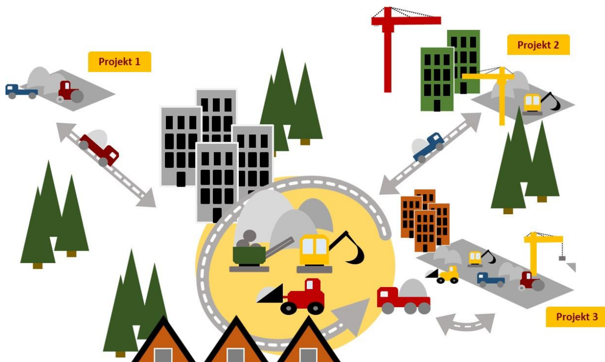
Figur 2. Illustration över hur ett masslogistikcenter (i mitten) tar emot, förädlar och lämnar ut material till olika projekt inom ett geografiskt område. Illustration: Sandra Frosth.
