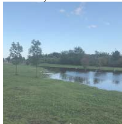
"Skålad" gräsmatta i södra Stockholm, utformad för att samla vatten efter kraftiga skyfall.
