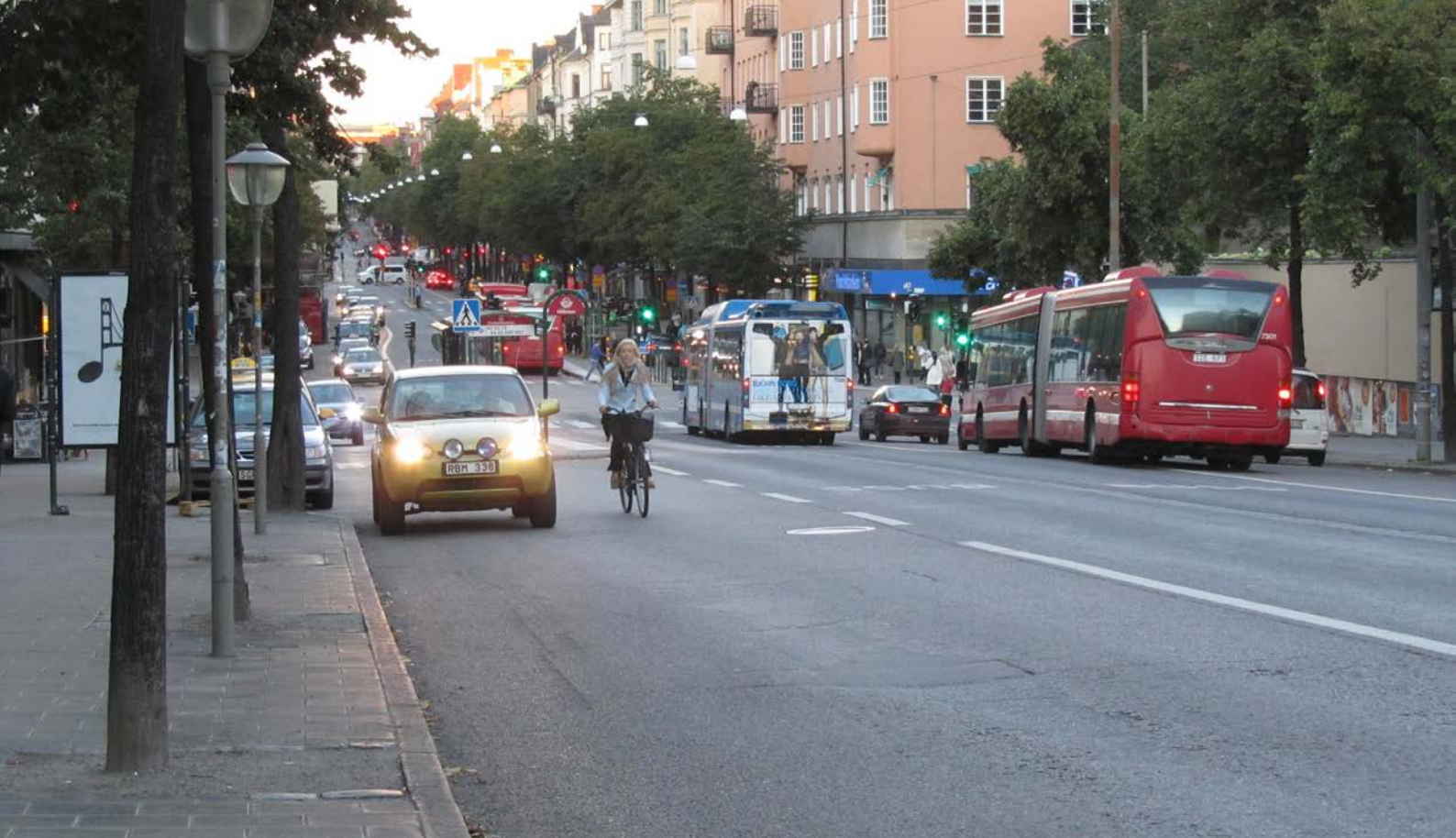
Bild 11: Exempel på fyrvägskorsning med mittförlagda busskörfält. Observera att hållplatserna ligger intill busskörfälten och att övrig trafik passerar på utsidan av plattformarna. Foto: Karin Hassner, WSP.
