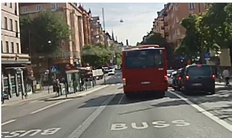
Bild 2: Mittförlagda busskörfält på Odengatan i Stockholm.
