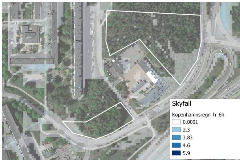
Figur 50: Översvämningsutbredning vid häftiga skyfall. Risken för översvämning idag är låg.
