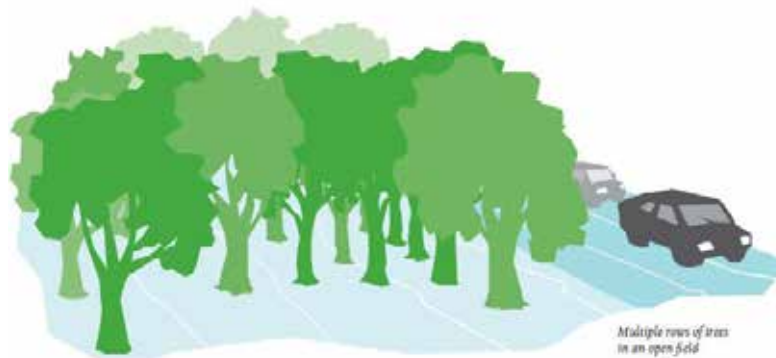
Ett 25 meter brett trädbälte intill vägarna kan dämpa bullernivån 7 dBA (The HOSANNA projekt 2013) Illustration: Tove Henix
