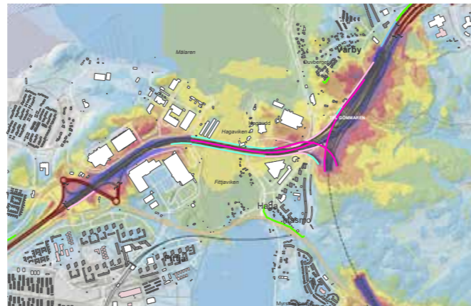
Utsnitt ur bullerkarta för Tvärförbindelse Södertörn med bullerdämpande åtgärder. Grönt visar 50-55 dBA, gult 55-60 dBA, orange 60-65 dBA, rött 65-70 dBA och lila 70-75 dBA ekvivalent ljudnivå. Kan jämföras med bullerkarta för nuläget (sid 42). Källa: Trafikverket.
