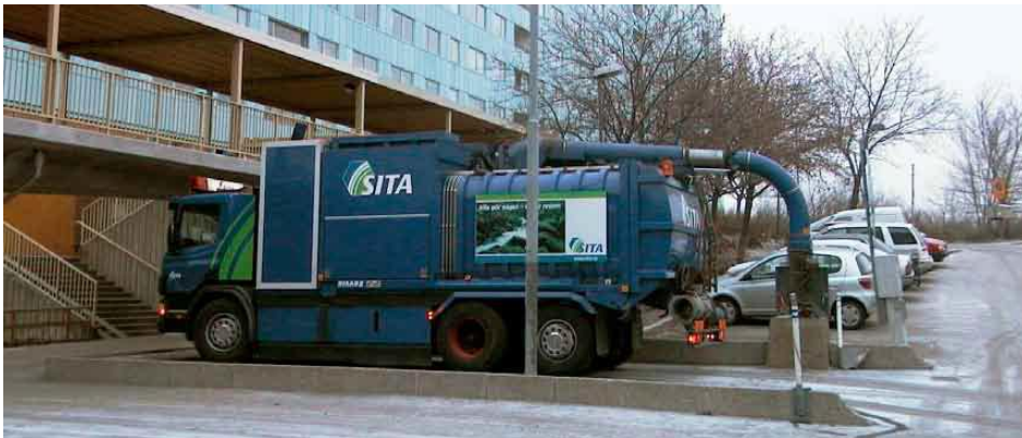
Figur 5 Sopsugsbil under tömning, markförlagd dockning med låsbar överdel
