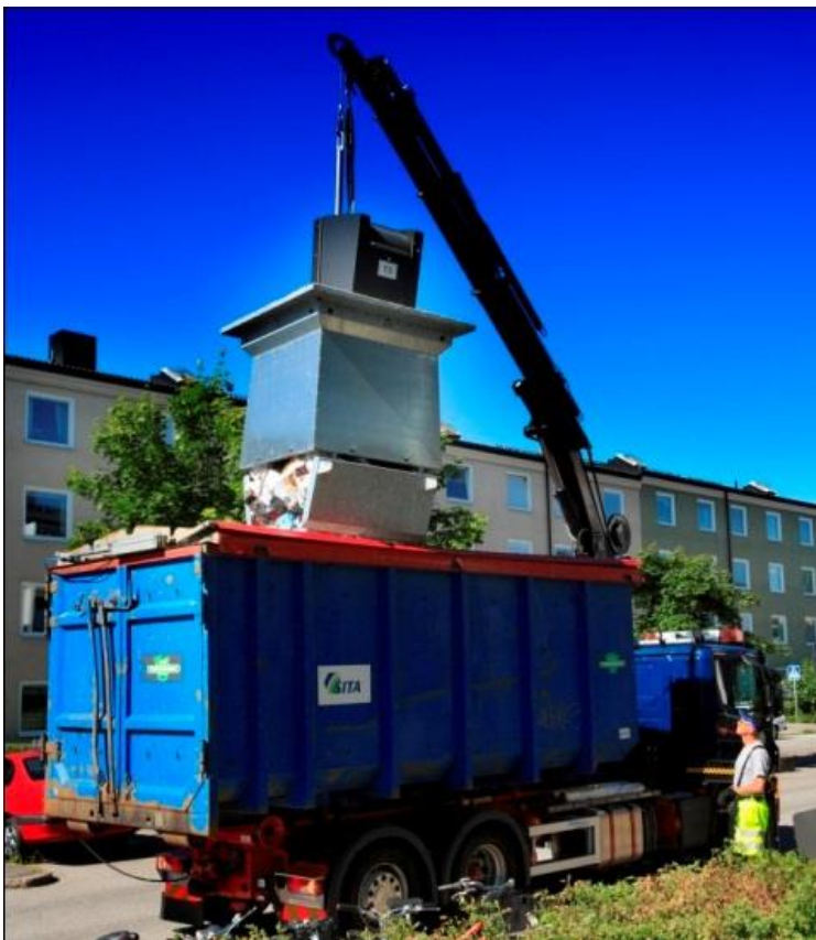
Figur 7 Bottenklaffarna öppnas vid tömning (PWS)
